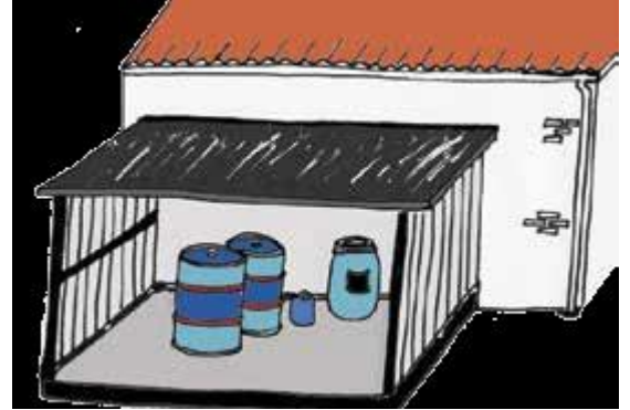
3 Udendørs opbevaring under tag med tæt bund og opkant
